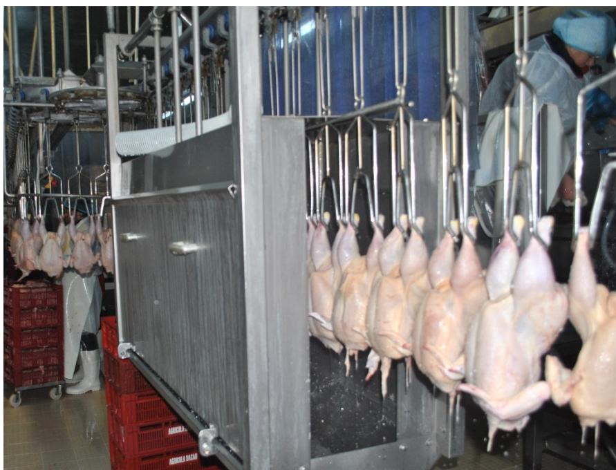
Figura nr. 9. Instalația automată de spălare a carcaselor eviscerate
