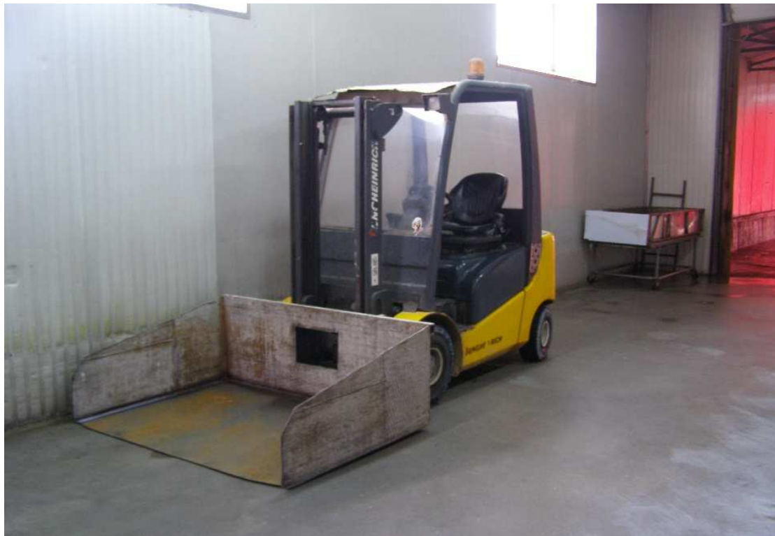
Figura nr. 2. Motostivuitoare utilizate pentru descărcarea păsărilor
