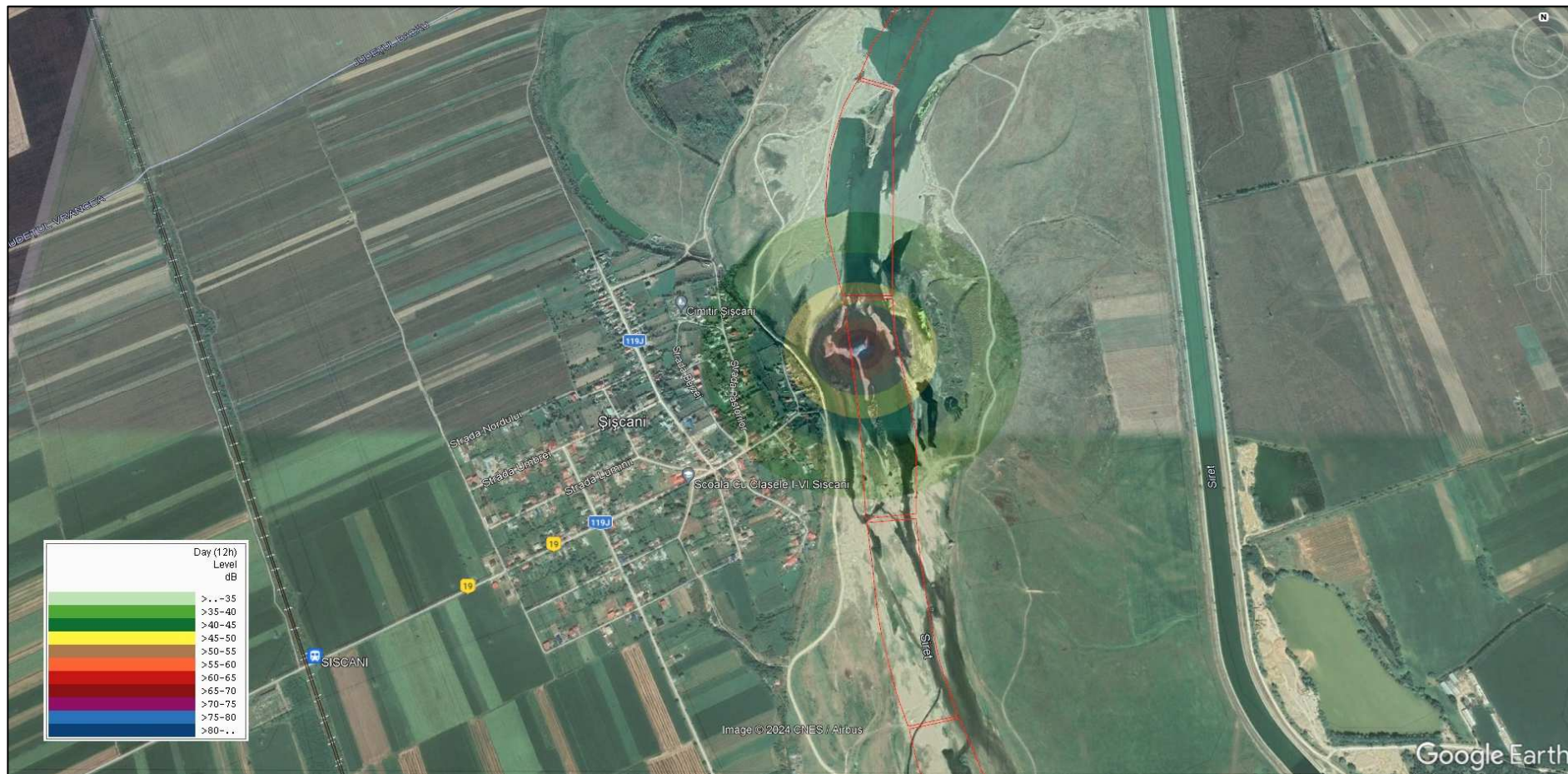
Figura nr. 21 - Hartă propagare zgomot de la perimetrul de exploatare
