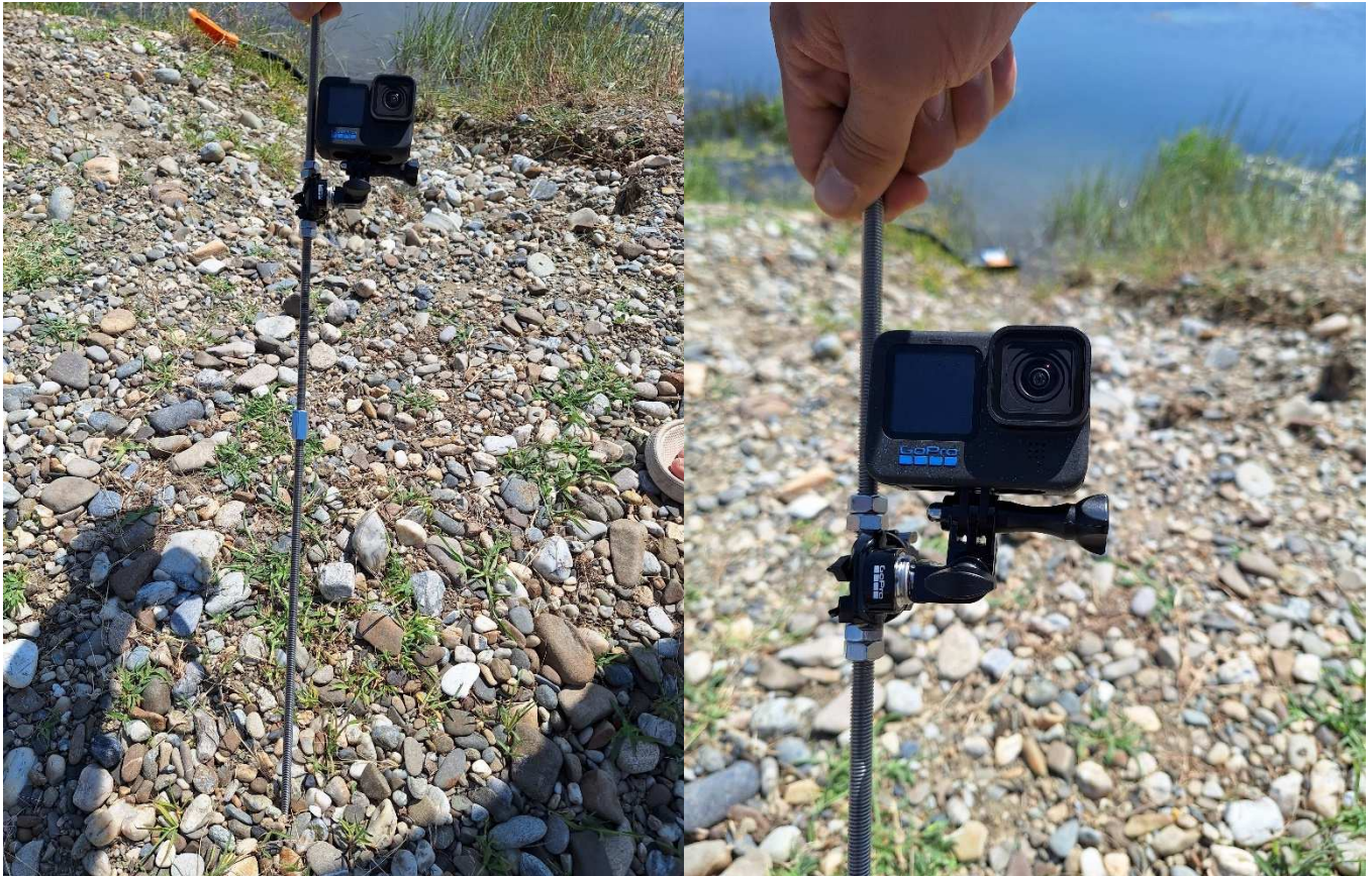
Figură 23 Fixarea camerei de acțiune pe suportul metalic
