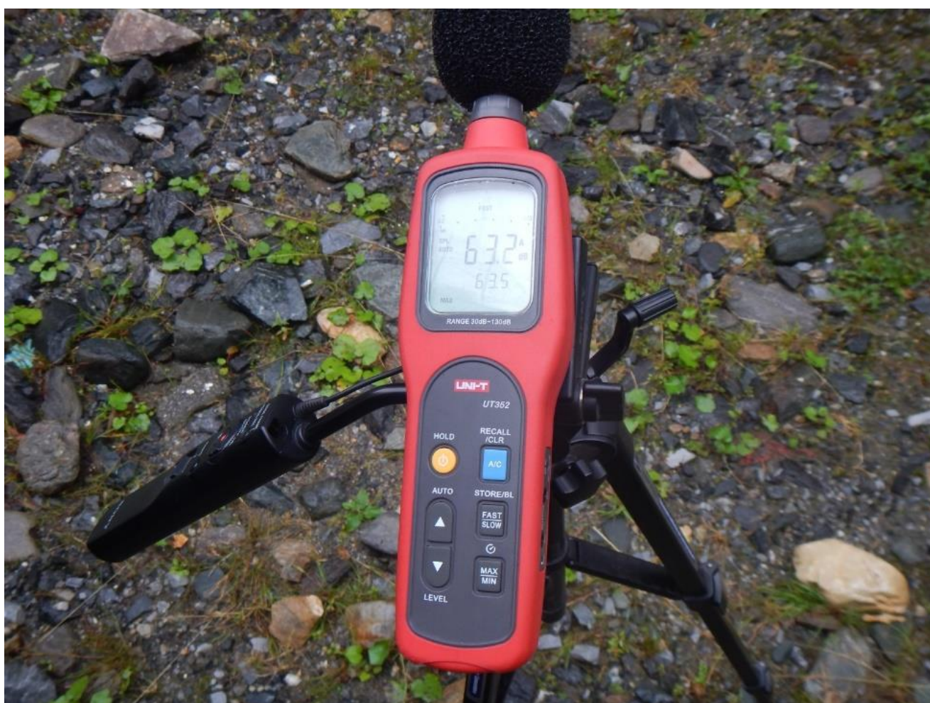
Figura 29. Sonometrul UNI-T model UT350 utilizat pentru măsurarea nivelului de zgomot în zona complexului turistic "Zaga-Zaga"
