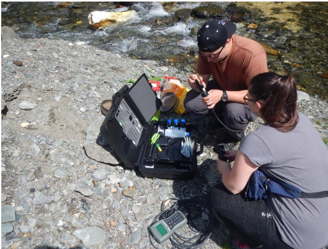
Figura 26. Măsurarea turbidității apei cu ajutorul analizorului portabil multiparametru Hanna 9289
