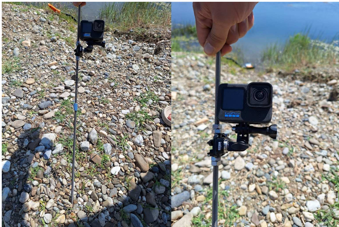
Figură 22 Fixarea camerei de acțiune pe suportul metalic
