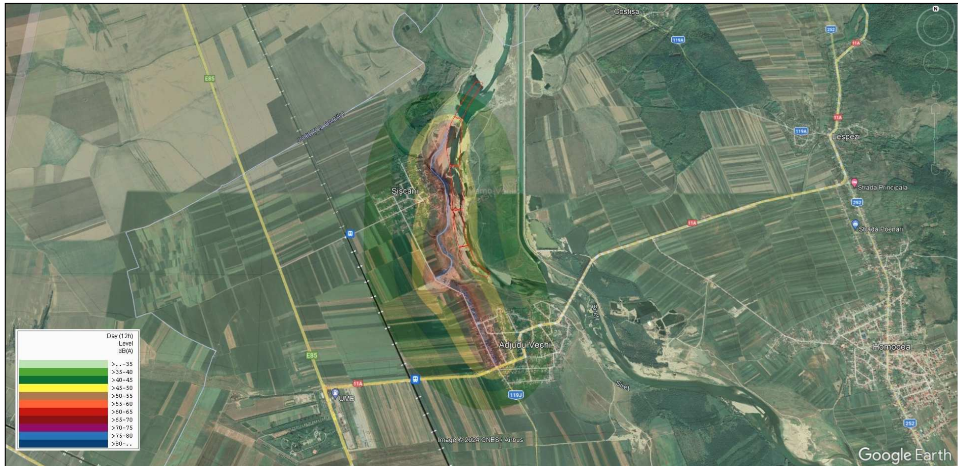
Figura nr. 21 - Hartă propagare zgomot de pe traseul parcurs de mijloacele de transport
